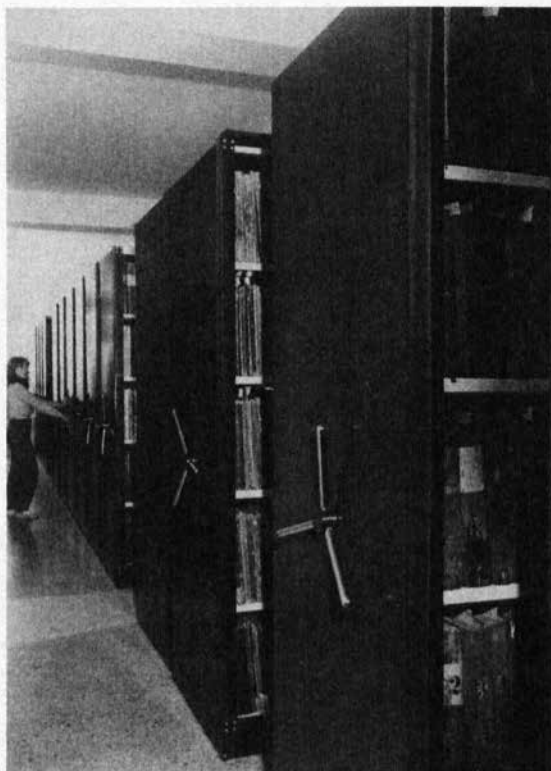
Abb. 2: Archivmagazin mit Kompaktusanlage (Foto Alfen, Aschaffenburg)
